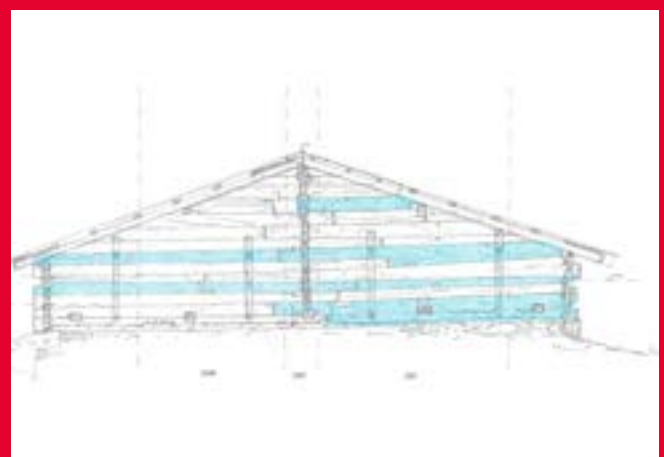
Historische Bauforschung, Südansicht (blau: zweitverwendete Hölzer)
